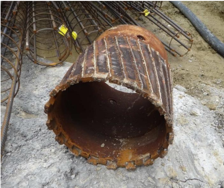
Figura 10: Detalhe da ponta do tubo, em aço-vídea, para possibilitar o corte
