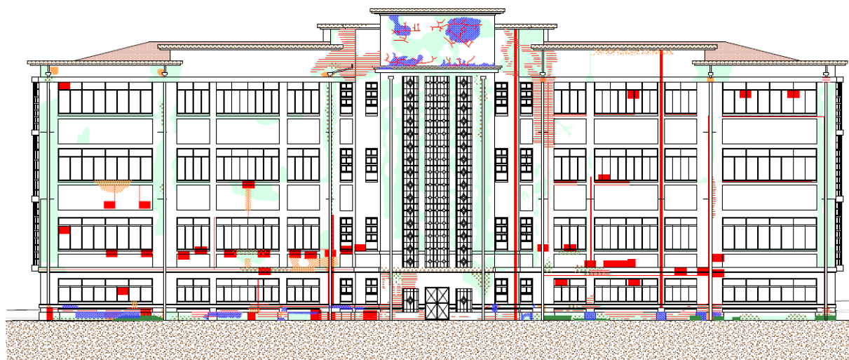
FACHADA OESTE- PATOLOGIA ESCALA 1:100
