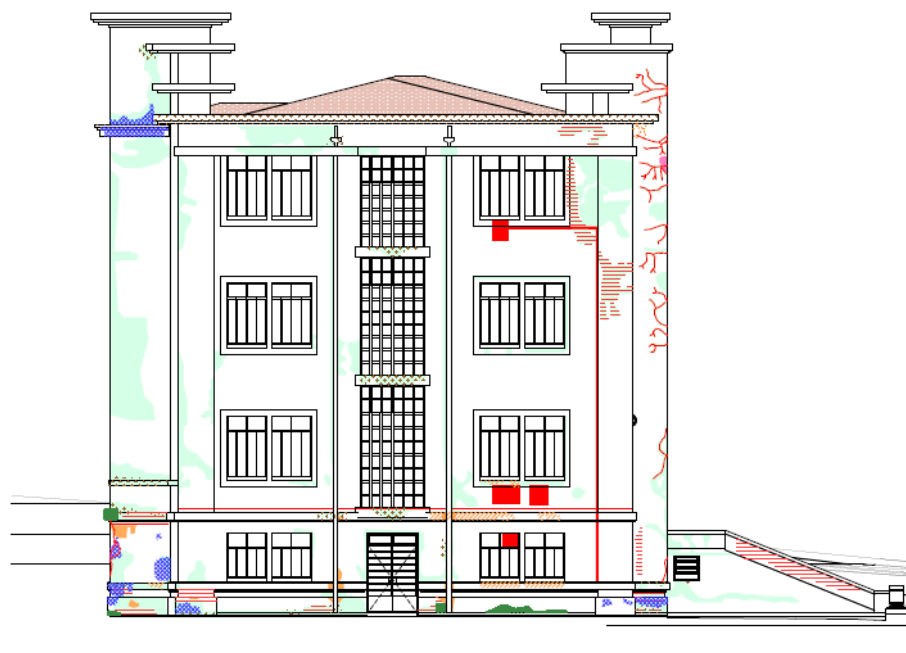
FACHADA SUL- PATOLOGIA ESCALA 1 : 100
