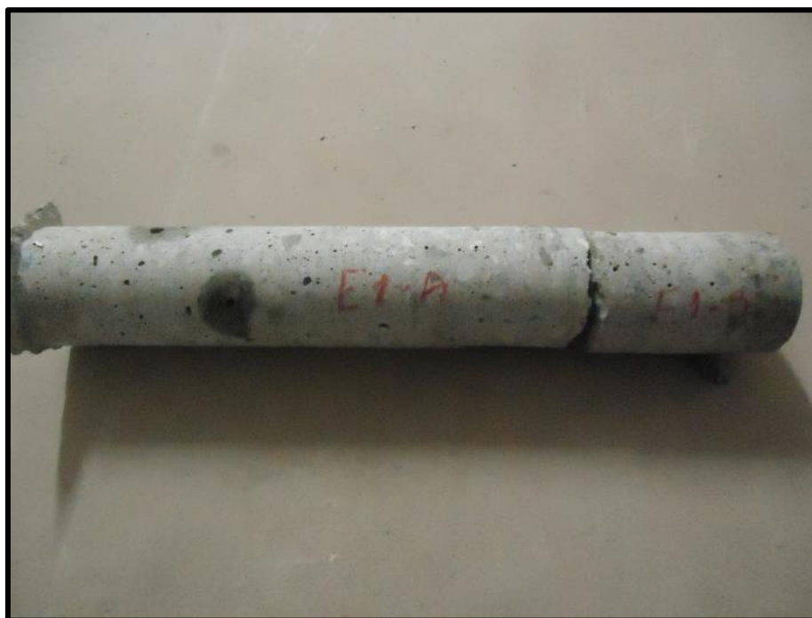
Foto 12 – Testemunho de concreto identificado para a realização de ensaios laboratoriais.
