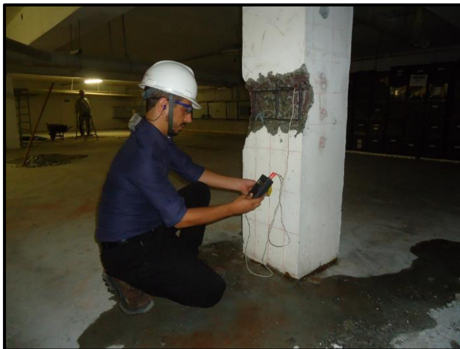
Foto 17 – Medida de potencial elétrico de corrosão.
