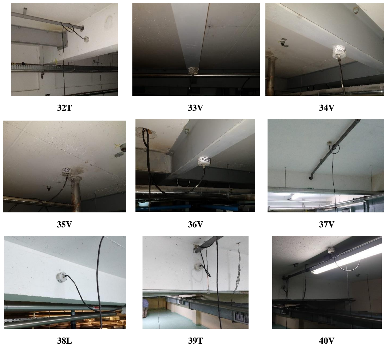
Figura 7 – Disposição dos transdutores de aceleração.
