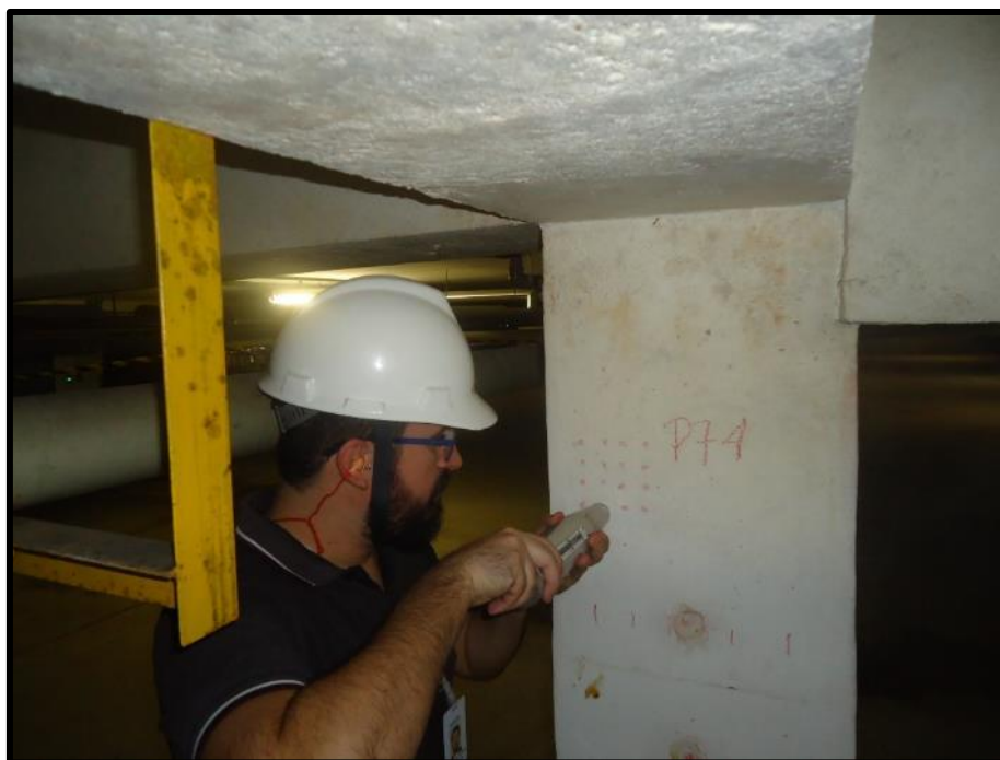
Foto 16 – Medida de dureza superficial com esclerômetro.
