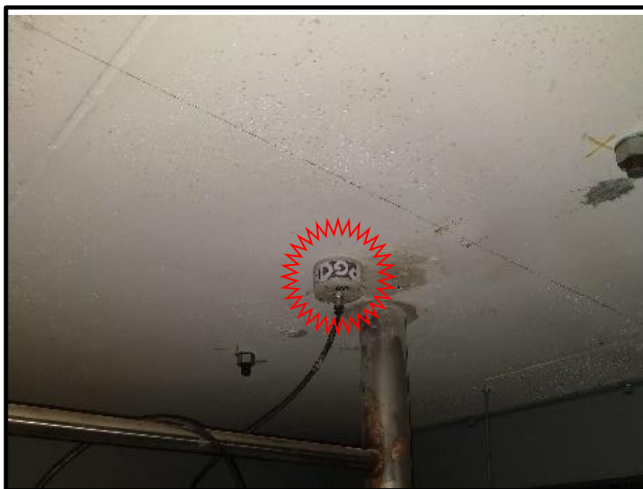
Foto 24 – Transdutor fixo na face inferior de laje do térreo.
