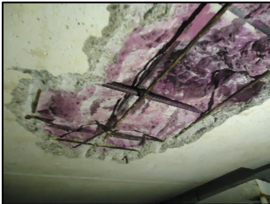
Foto 15 – Profundidade de carbonatação mediante a aspensão de solução de fenolftaleína, em laje.
