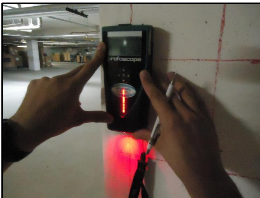
Foto 7 – Realização de pacometria para detecção de armaduras.
