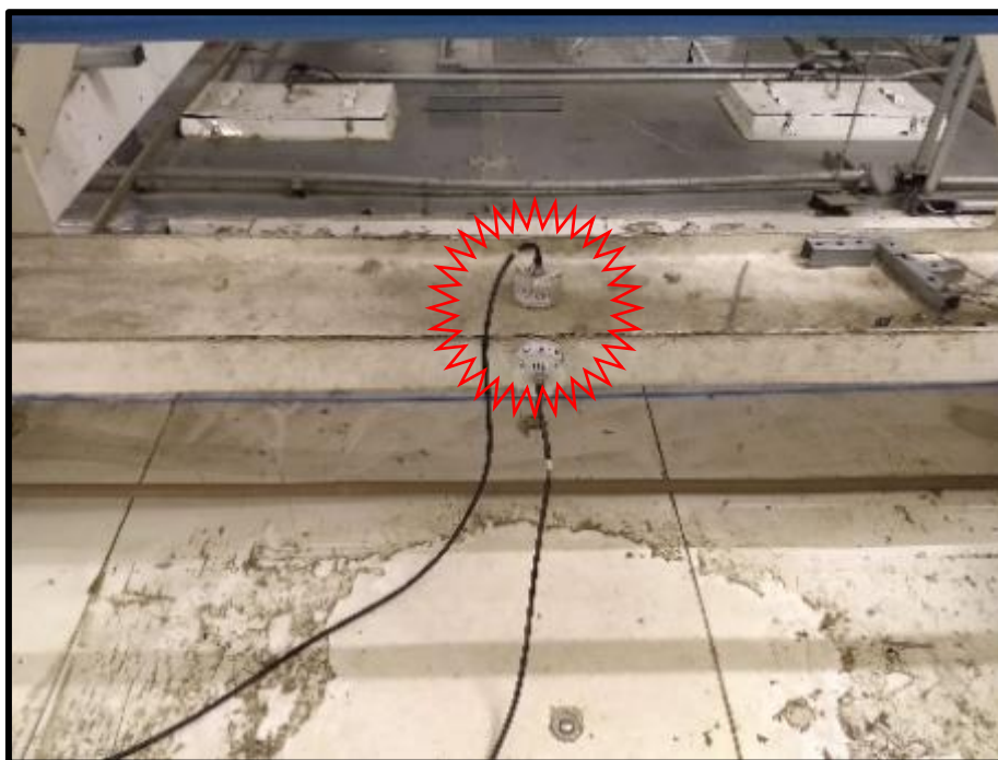
Foto 22 – Transdutores fixos a estrutura metálica.
