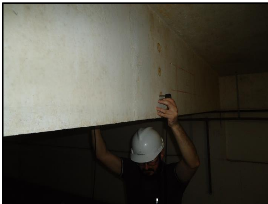
Foto 13 – Medida de velocidade de propagação de ondas de ultrassom – Medida direta.
