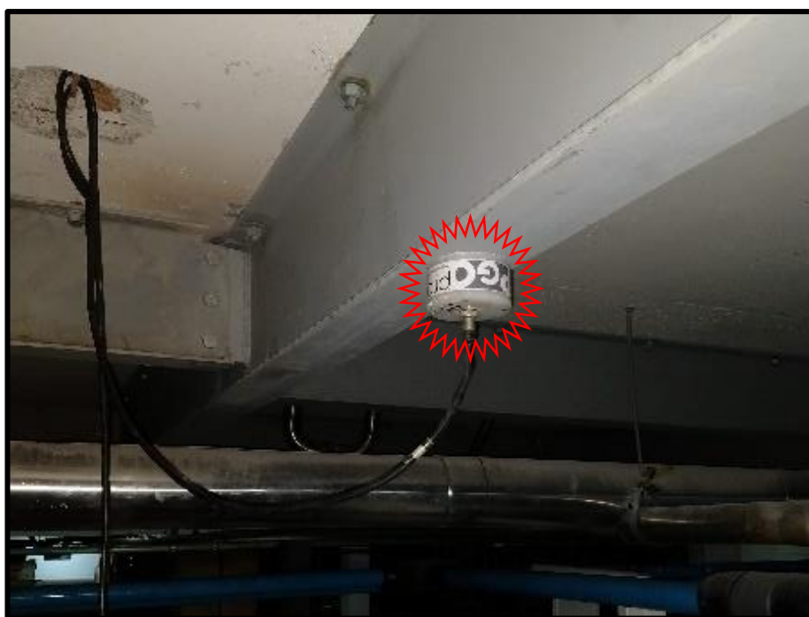
Foto 25 – Transdutor fixo em estrutura metálica de reforço das lajes do térreo.
