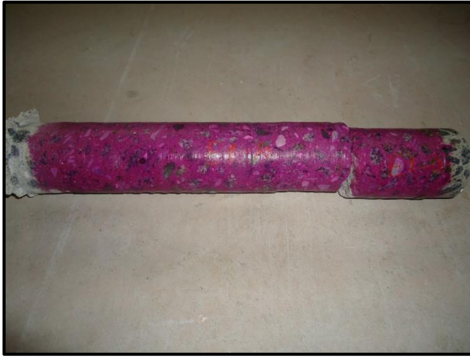
Foto 14 – Profundidade de carbonatação mediante a aspensão de solução de fenolftaleína, em testemunho de concreto.
