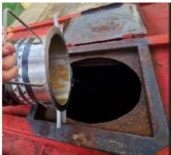
Figura 3: Bocal de acoplamento do flexível de descarte do resíduo com a caçamba coletora.
