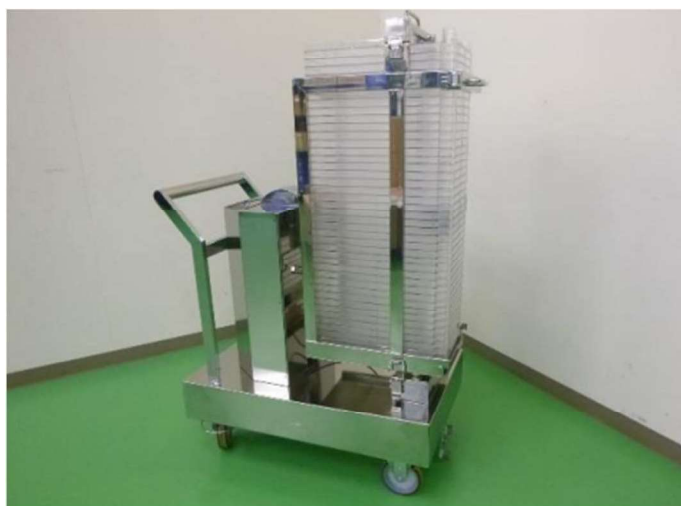
Item 04. Manipulador manual para suporte para frascos de 40 camadas.
