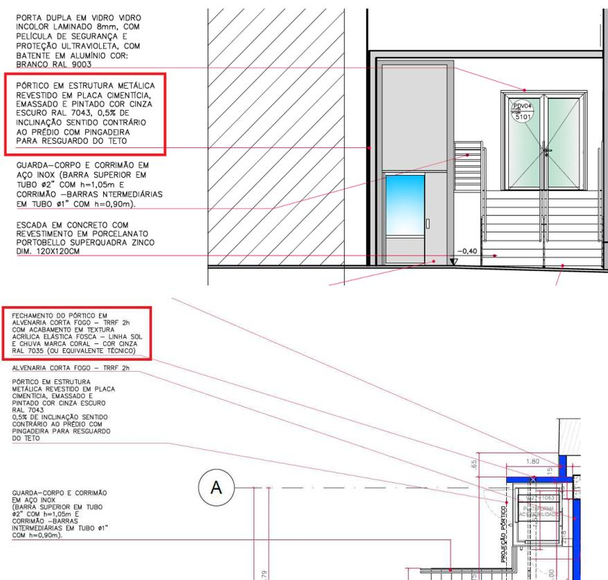
**RESPOSTA:** Para o pórtico considerar estrutura metálica revestida com placa cimentícia. Com relação à localização das paredes de alvenaria resistente ao fogo consultar documento de SPCI DI-01027-PE-IN-DE-0004\_05.
